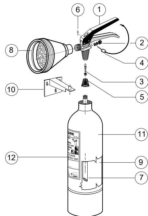
\*\* Marchiatura serbatoio (Ente di Sorveglianza) **CE 1370**, produttore serbatoio, decimale anno produzione, (codice identificativo produttore) **0095**, n° matricola serbatoio, (Pressione di collasso) PT xx Bar.
